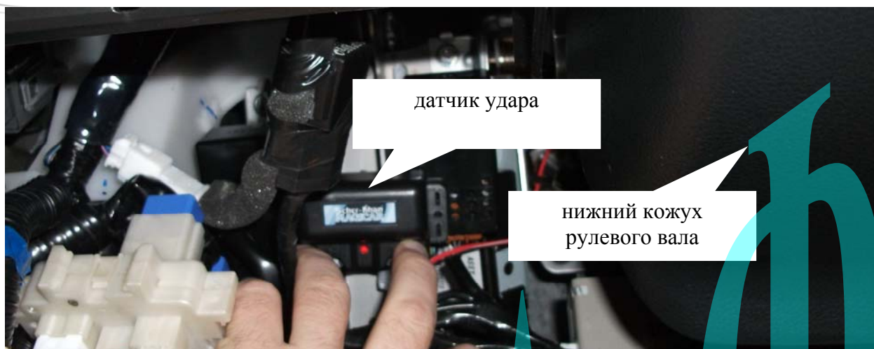
Рис. 10: Возможное место установки датчика удара.
